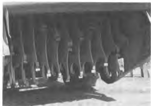
写真-2 切削刃(ビット)状況
