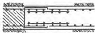
(鋼製函体は先行掘り込みし、継手部コンクリートは後行倒エレメントと同時打設とする)
