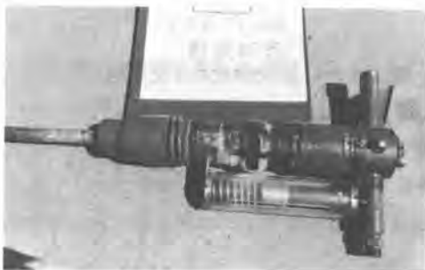
写真-1 空圧式ブレーカ用動吸振器(併軸型)
