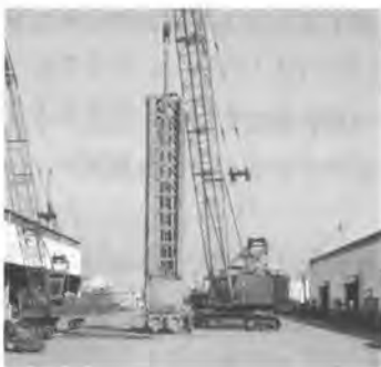
クローラクレーンをベースマシンとしたハイドロフレーズ
