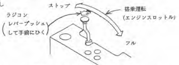
図5 ラジコンや搭乗運転の切換えレバー
