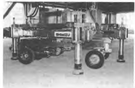
写真-2 駆動系を旋回させるSSR-2
