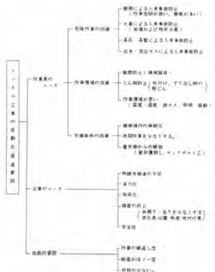
図-1 トンネル工事の自動化促進要因
