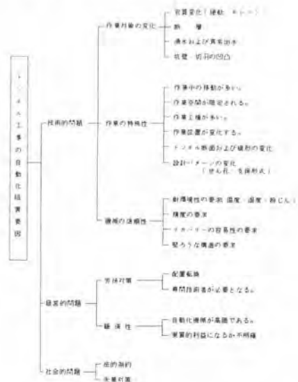
図-2 トンネル工事の自動化阻害要因
