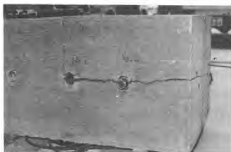
写真-4 ハイドロ・クラッカーによる破碎状況
