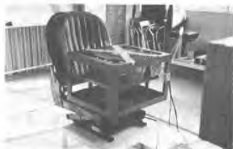
写真-2 動吸振器内蔵型サスペンションシート
