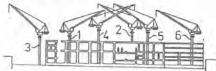
図-7. タワークレーン配置図(立面)
