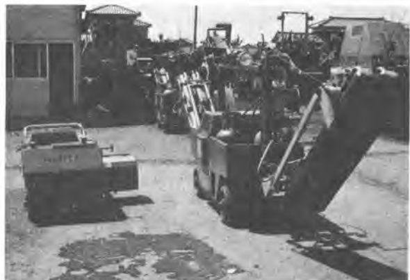
写真-2 小型リフォーマとジョイントヒーター車
