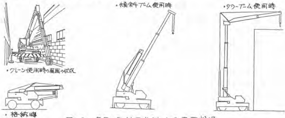
図-2. タワ-型油圧式クレーンの使用状況
