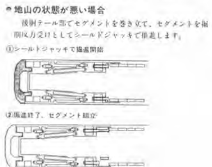
図-3 掘削順序図(2)
