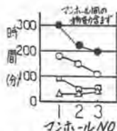
図-6. マンホール埋戻機施工時間
