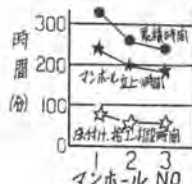
図-7. マンホール設置機施工時間
