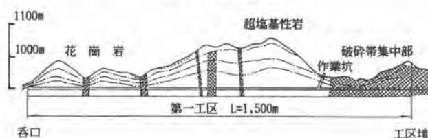
図-2 地質縦断面
