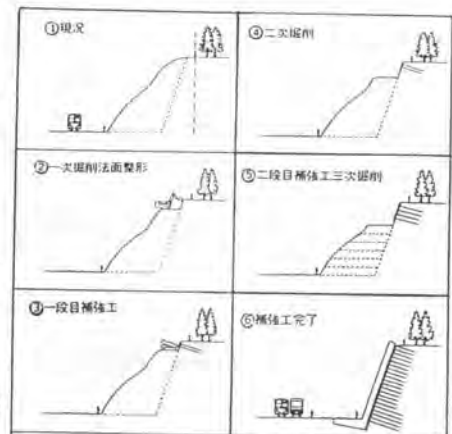
図-1 施工順序図
