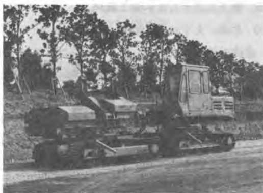
写真-3 フィニッシャ用アンカー車
