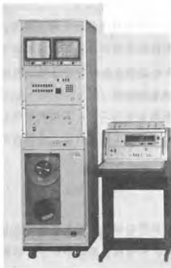
写真-2 わだち掘れ&縦断凹凸一次処理装置
