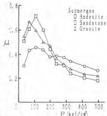
図6 種々の岩石に対する摩擦係数μと接触面圧Pの関係(水浸状態)
