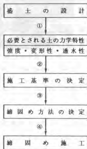
図-2 合理的な締固め施工
