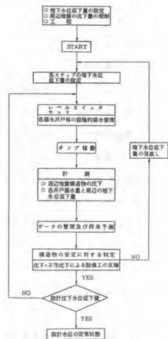
図-10 揚水コントロールフロー
