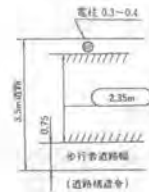
図2. 道路幅3.5mでの工事想定図
