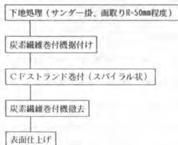
図-2 柱の補強フロー図
