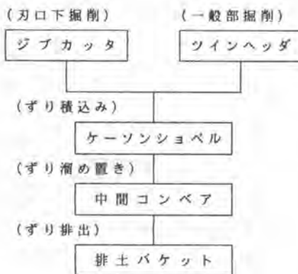
図-2 土丹掘削時の使用機械
