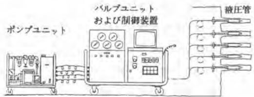
図-4 高水圧破碎装置
