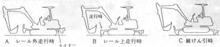
図2 クローラ系の走行（ライナーの状態）
