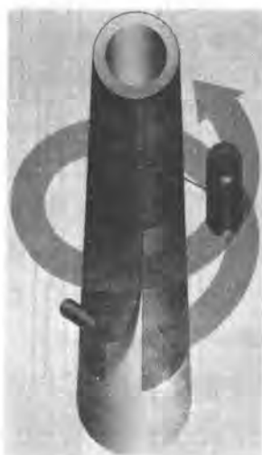
図-2 炭素繊維による補強概念
