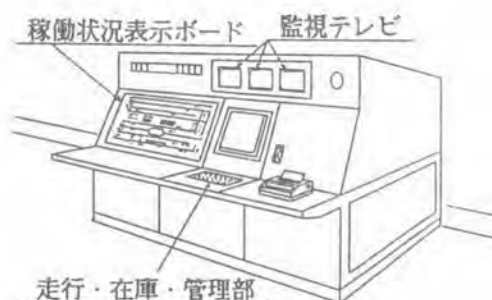
図-5 中央監視装置
