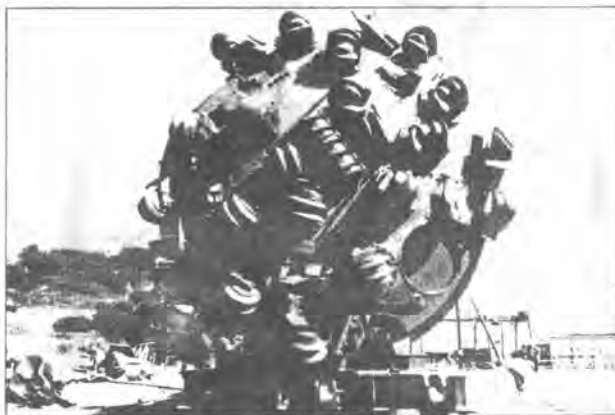
写真-1 TBM(正面)
