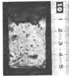
写真2.3 試験体断面 上部の黒い部分が緻密層
