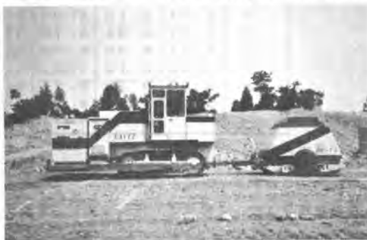
写真1-1 牽引式MVT施工機 (LAVIT)
