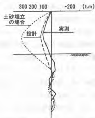
図6 鋼矢板の曲げモーメント
