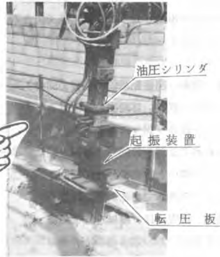
写真-2 狭あい部締固め装置（垂直転圧板接続）
