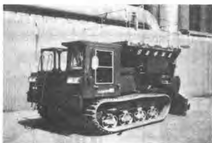
写真-4 石灰・セメント散布機
