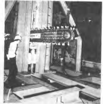
写真-1 薄壁掘削機全景
