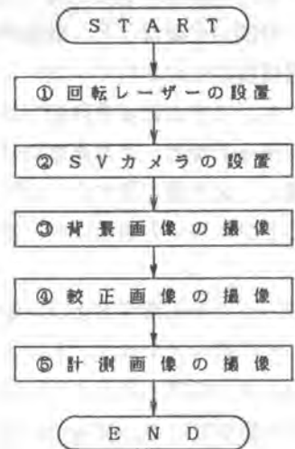
図-2 坑内計測フロー
