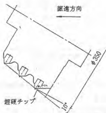
図5 非対称チップインサート型切頭円錐型3連ローラビット形状
