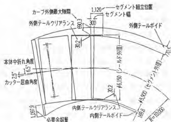
図-1 R=10m掘進時の状態図
