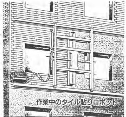
図-1 タイル貼りロボット構想図 (作業中)
