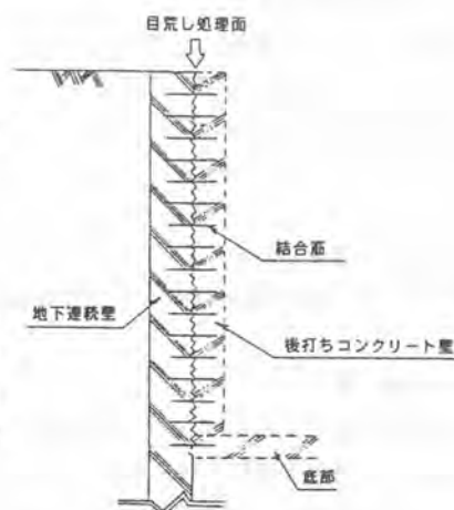
図-2 本体組込み地下式連続壁工法概略図
