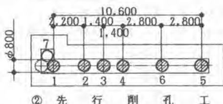
② 先行削孔工
