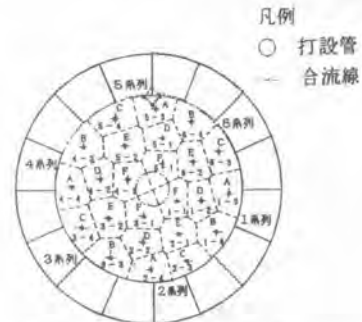
図-2 内核部の打設管配置例
