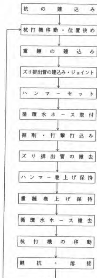
図-2 施工フロー
