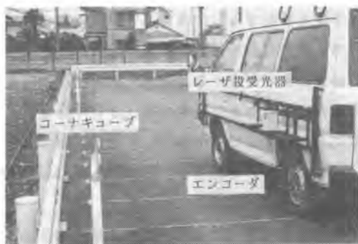
写真-2 実験車に取り付けた各種センサー
