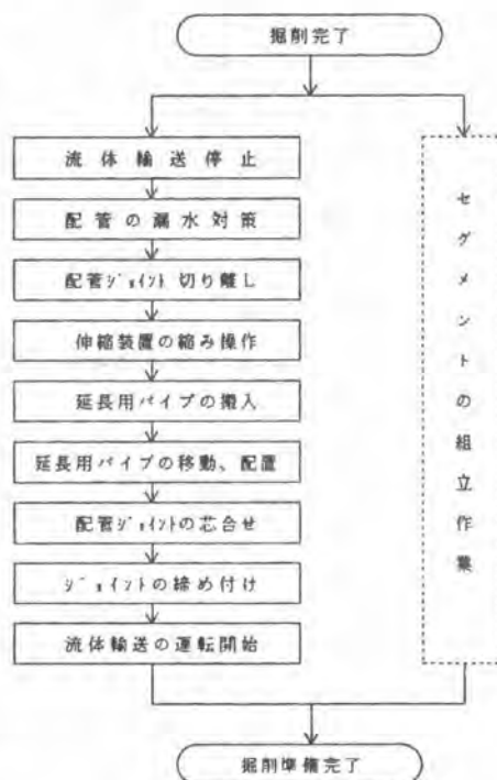
図-1 送排泥管延長の施工手順
