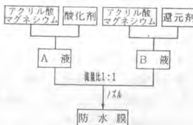
図-1 防水膜の形成フロー
