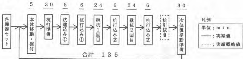
図-4 杭打サイクルタイム(平均)
