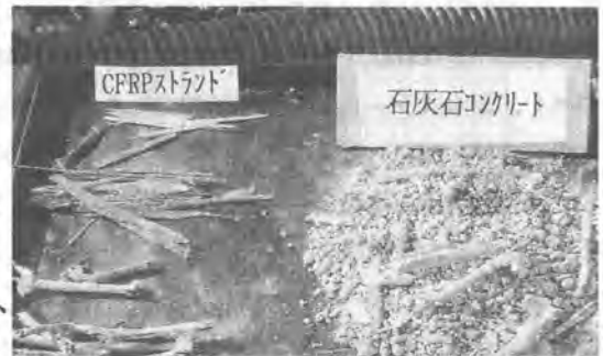
写真-1 切削ずり
