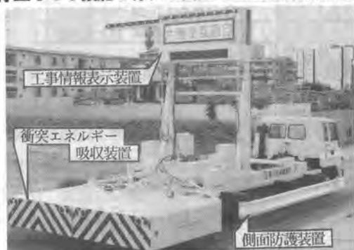
写真－1 突入防止車全景（設置状態）
