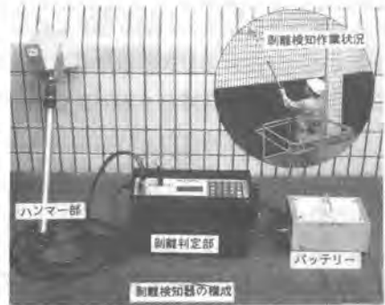
写真-2 装置の構成と作業状況
